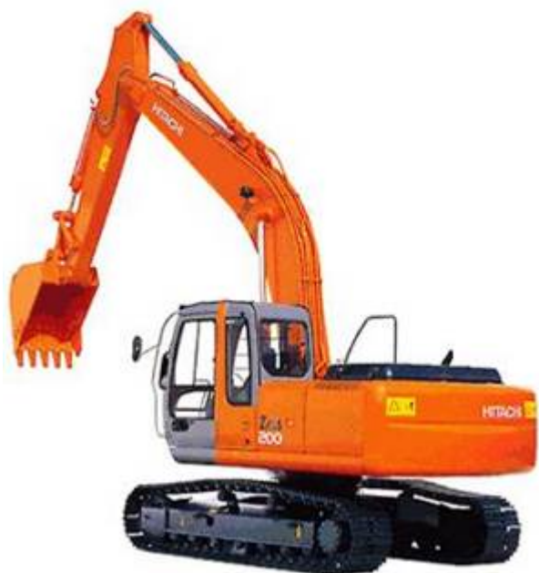
Рисунок 1. Одноковшовый, гидравлический экскаватор Hitachi ZX200-3
