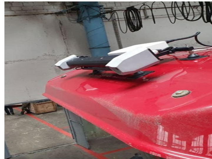
НА КРЫШЕ КОМБАЙНА (V.2) / модуль навигации в осеннем релизе 2022 г.
