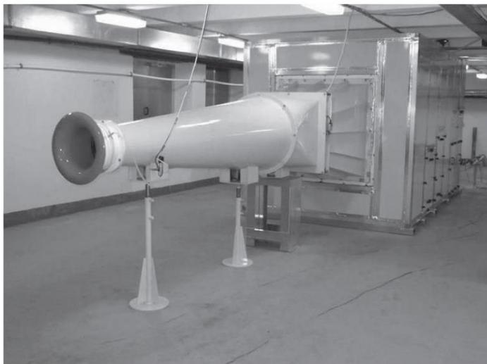
Стенд используется для испытаний радиальных и осевых вентиляторов и вентиляционных элементов с 2009 года.
