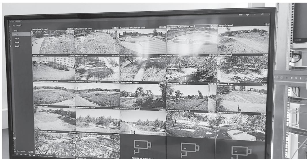
компании «ВИПАКС» в Перми. Конструкция камер разработана так, чтобы работать в любых погодных условиях, выдерживать многократное обледенение, сильные порывы ветра и прямые лучи солнца. Видеокамеры дают обзор всей территории площадки, не оставляя слепых зон. Транслируемое изображение с разрешением QHD обладает высокой детализацией и позволяет рассмотреть лица людей и номера машин. Эта информация помогает оперативно расследовать происшествия.
